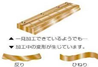
薄物ワークの加工を行う場合はチャッキングの方法が一つのポイントとなります。薄物ワークを普通にチャッキングして加工すると、一見形にすることは可能です。しかし、加工後の製品には、反りやひねり、変形などが発生してしまい、製品として使い物にならないことが多々生じます。薄物ワークの加工を行う際には、しっかりとワークを把持し、かつ加工中に変形のないチャッキング方法を考える必要があります。
