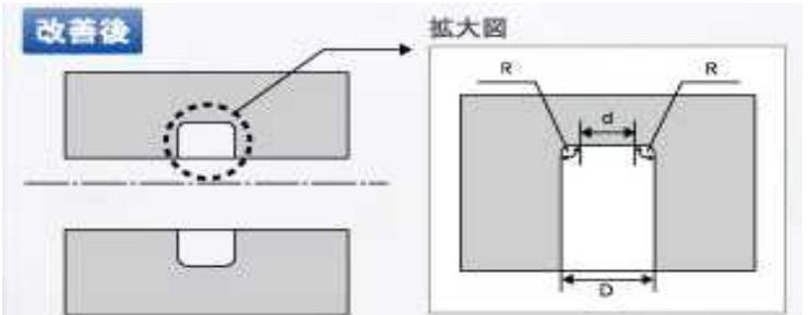
旋盤加工の場合溝底部に合ったRを指示しなければなりません。考え方を公式で示すと  $D > 2d + R$   $d/2$  を目安として考えるとスムーズに加工を進める事が可能です。
