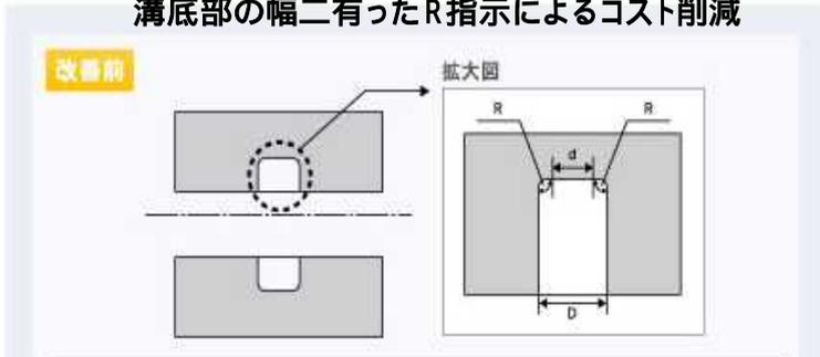
上図の様に溝底部に合ったR指示をしなければ、削り出す為に新たに特殊なバイトが必要となり加工コストが大幅に増加してしまいます。
