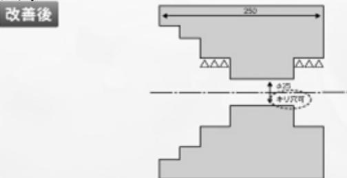
上図の様に、遊び部にキリ穴指示をする事でドリル1工程で仕上げる事が出来、加工工数を削減する事が出来ます。すなわち図面に細かい指示をする事で加工コストの削減は可能になるという事です。
