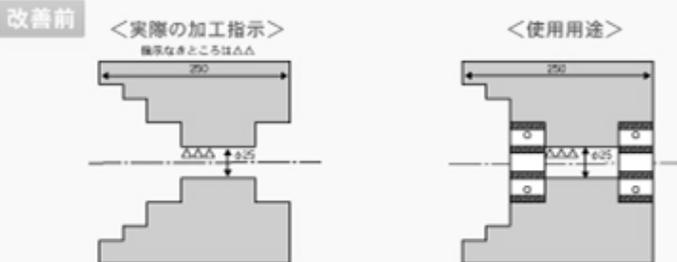
実際の各支持指示では遊び部にも面粗度が要求されている為ドリルでの穴加工後バイトで切削するのは加工工数が増加してしまいます。
