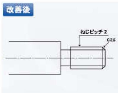
ネジ部角面のCが、ネジ山高さよりも小さいと、バリが発生する原因になります。
