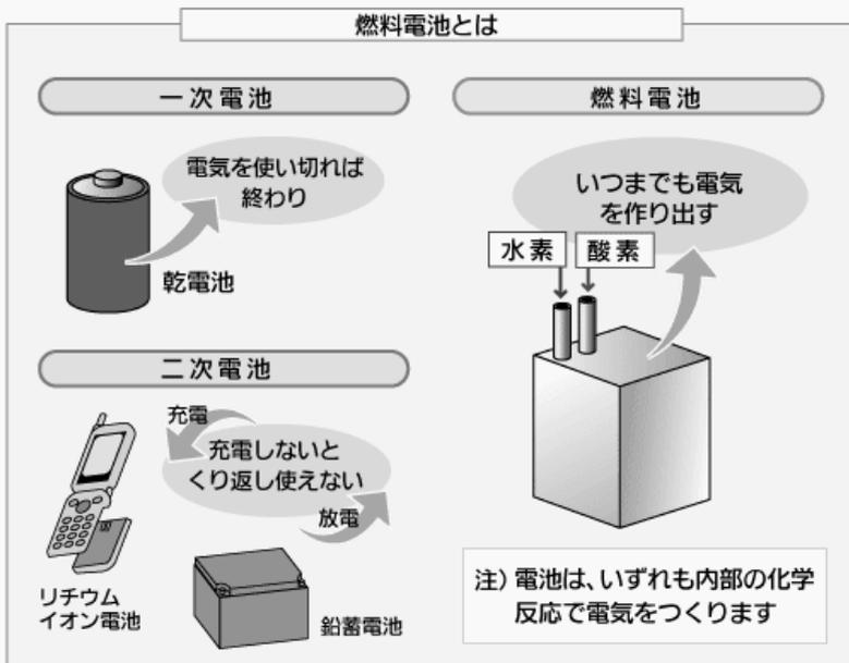
今後電力需要は地球規模で見ても増大の一途を辿ると見られます。これまで、電力は一般的にはその殆どを電力会社が発電し、送電したものを充電する仕組みでしたが、その様な状況の中で今回の原発事故や災害等により電力供給量が減少する様な状況が生まれた場合は、大規模発電システム中心で有ればそれが原子力発電であろうが再生可能な発電システムであろうが、貯蔵しにくい電気の特性からすると分散型発電システムとの併用が望ましいのではと云われています。燃料電池は空気中の酸素と天然ガスから作った水素で発電します。天然ガス自体、大変クリーンですし、埋蔵量も石油の比では有りません。また今注目のメタンハイドレートからも水素は生成できます。電力も必要な時に必要なだけ発電できるような状況が燃料発電システムです。
